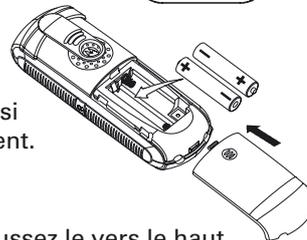
Remplacez le couvercle sur le compartiment piles et poussez-le vers le haut jusqu'à ce qu'il se ferme correctement. Placez le combiné sur la base. Un bip de confirmation puis l'indicateur de charge confirme que le chargement a commencé.
