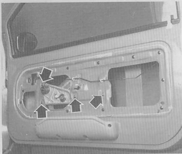
Vis de fixation d'un mécanisme de lève-vitre.
